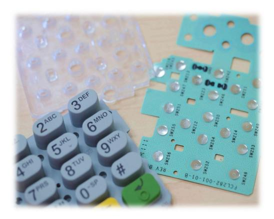
KEYPAD + LIGHT GUIDE + METAL DOME ASSY KEYPAD
